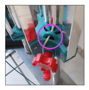
Führen Sie das neue Zugseil bis zur oberen Krone und schieben das Seil durch die Öffnung in der Krone. Verknoten Sie das Ende, damit es nicht zurück durch das Loch rutschen kann.
